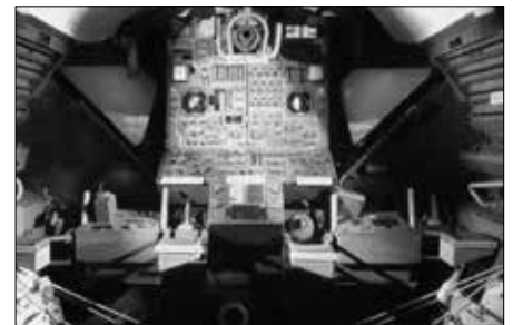
Der LM-Innenraum mit der Bedienungskonsole.
